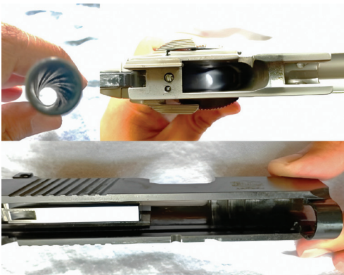
รูปที่ 3 คราบเขม่าหลังจากการทดสอบยิง
