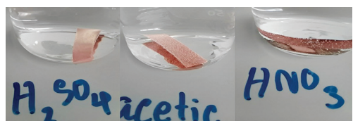
รูปที่ 7 ฟองก๊าซที่เกิดขึ้นบนแผ่นโลหะทองแดงที่แช่ในสารละลายกรดซัลฟิวริก กรดแอซติก และกรดไนตริก ขณะเริ่มต้นการทดลอง
