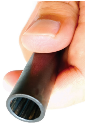
รูปที่ 15 ภาพหลังล้างลำกล้องปืนด้วยน้ำยาล้างคราบทองแดง
