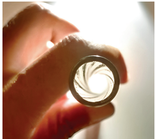
รูปที่ 12 ภาพลำกล้องปืนหลังจากทำความสะอาดด้วยน้ำยาล้างคราบเขม่า
