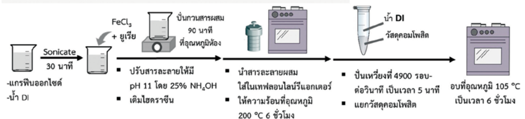
รูปที่ ๒ วิธีการสังเคราะห์วัสดุคอมโพสิตระหว่างเหล็กออกไซด์นาโนและแกรฟีน
