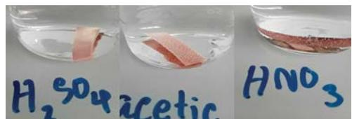
รูปที่ 7 ฟองก๊าซที่เกิดขึ้นบนแผ่นโลหะทองแดงที่แช่ในสารละลายกรดซัลฟิวริก กรดแอซติก และกรดไนตริก ขณะเริ่มต้นการทดลอง
