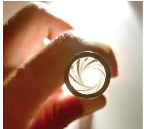
รูปที่ ๑๒ ภาพลำกล้องปืนหลังจากทำความสะอาดด้วยน้ำยาล้างคราบเขม่า
