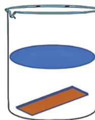
รูปที่ ๒ การทดลองใส่แผ่นทองแดงบริสุทธิ์ลงในสารละลายกรด สารละลายเบส และสารละลายออกซิไดซ์
