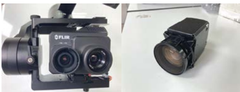
รูปที่ 6 กล้องแบบเลนส์ทางยาวโฟกัสเดี่ยว (ซ้าย) และกล้องแบบเลนส์ซูม (ขวา)
