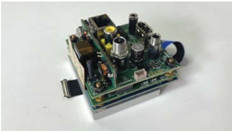
รูปที่ 5 ระบบแปลงสัญญาณภาพ รุ่น Lightweight Dual Camera Full 4K Encoder (FV4K-DCK-15)
