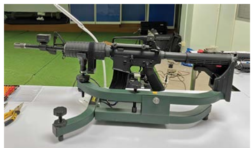
รูปที่ ๙ ตำแหน่งที่ติดตั้งชุดเลเซอร์อินฟราเรดบนกระบอกปืนรุ่น M4A1
