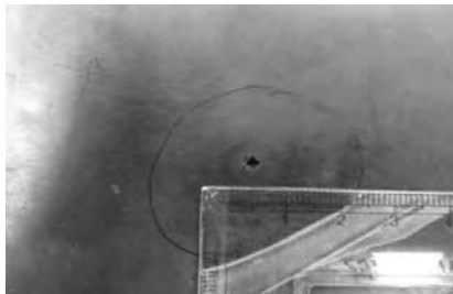
ข) แสดงรูกระสุนขาออกของแผ่นทดสอบยางเสริมเส้นใยเคพลาร์
