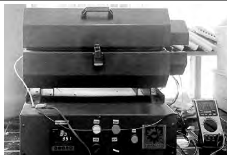
รูปที่ 4 การให้ความร้อนเซลล์แบตเตอรี่ใน Tube Furnace
