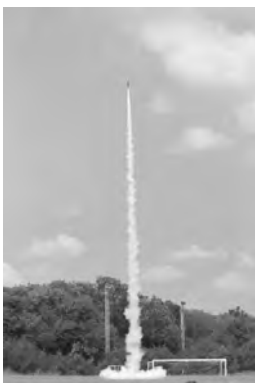
รูปที่ 9 แสดงการยิงทดสอบจรวดประดิษฐ์ เพื่อวิเคราะห์การทำงานและความสูง
