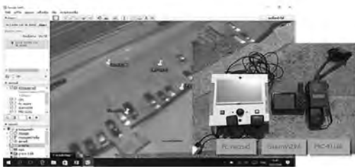
รูปที่ 6 การเปรียบเทียบตำแหน่งของต้นแบบเครื่องบินที่กาดำแหน่งท่าทางการบินกับเครื่องรับ GPS รุ่น Garmin 296 และ PRC-112G เทียบกับจุดอ้างอิง
