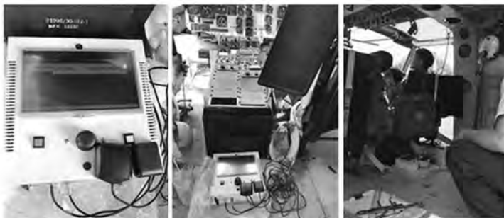
รูปที่ 9 แสดงการติดตั้งต้นแบบเครื่องบินที่กาดำแหน่งและท่าทางการบินบนเฮลิคอปเตอร์แบบ UH-1H
