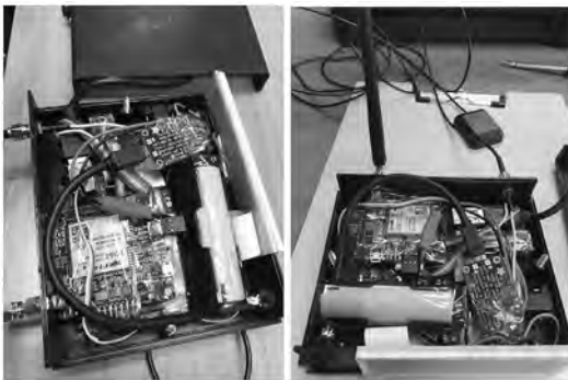
รูปที่ 12 การพัฒนาต้นแบบเครื่องบินที่ตำแหน่งและท่าทางการบิน
