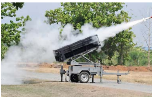
รูปที่ ๑๒ การทดสอบภาคพลวัตจรวดดับเพลิง
