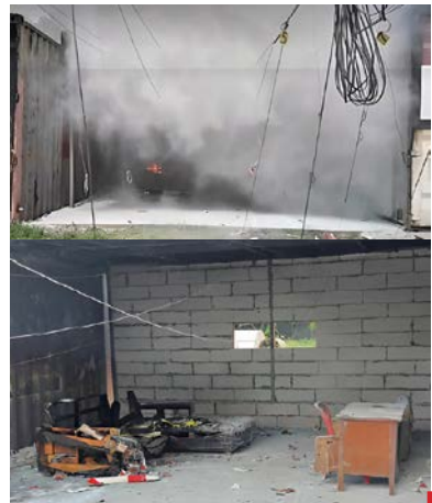
รูปที่ ๒๔ แสดงกลุ่มไฟก่อนส่งจรวดเข้าห้วงไฟ (ดับไฟ)
