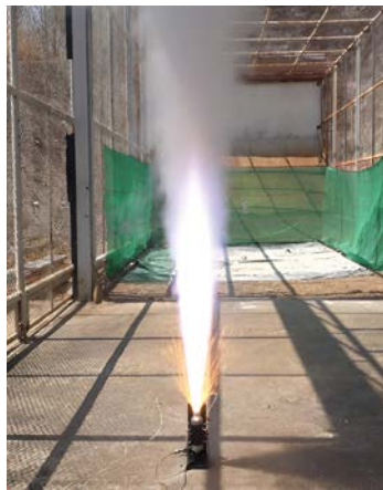
รูปที่ ๑๐ การจุดทดสอบภาคสถิตมอเตอร์จรวดดับเพลิง
