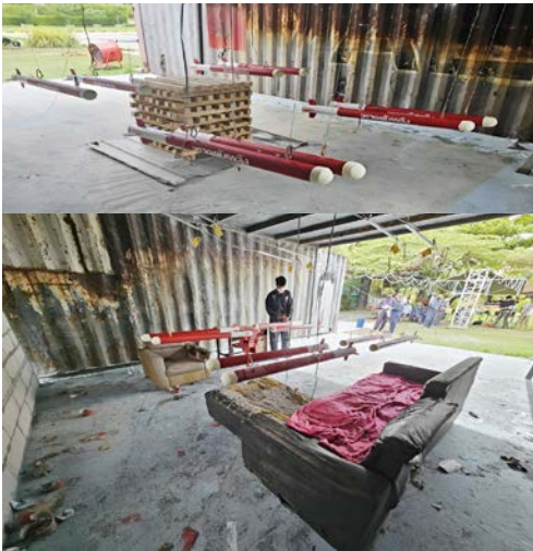
รูปที่ ๑๔ การทดสอบประสิทธิภาพการหน่วงไฟ
