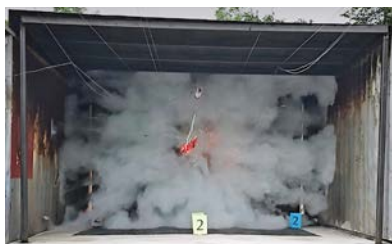
รูปที่ 21 การกระจายสารดับเพลิงในพื้นที่ปิด
