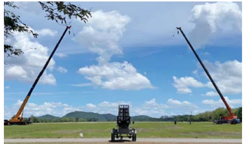
รูปที่ ๑๘ การติดตั้งเป้าเพื่อทดสอบภาคพลวัต
