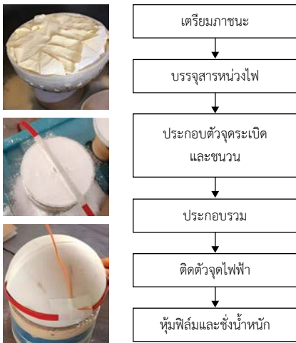
รูปที่ ๕ กระบวนการประกอบเครื่องดับเพลิง
