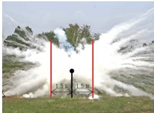
รูปที่ ๘ ผลการทดสอบภาคสนามของเครื่องดับเพลิงภาชนะวัสดุกระดาษคราฟต์
