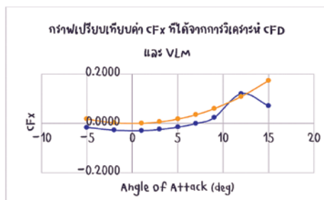
รูปที่ 5 กราฟเปรียบเทียบค่า C_{FZ} ที่ได้จากวิธีการวิเคราะห์ CFD (น้ำเงิน) และ VLM (เหลือง)
