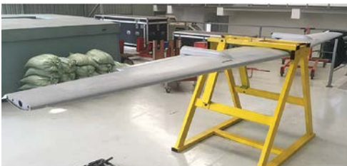
รูปที่ 16 โครงสร้างปีกไทเกอร์ชาร์ก 2 (แผนแบบเดิม) ติดตั้งประจำแท่นทดสอบ
