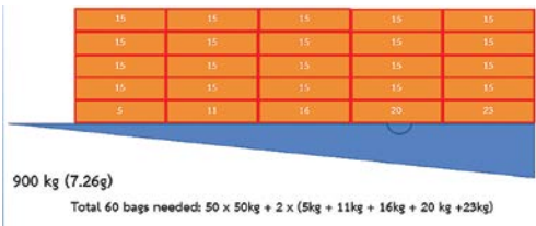
รูปที่ 18 รูปแบบการวางถุงทรายบนปีก
