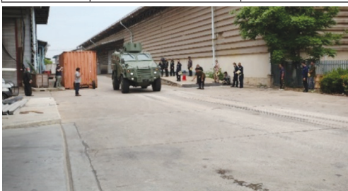
รูปที่ 10 การทดสอบการวัดระยะเบรกของรถ โดยการวิ่งที่ความเร็ว 40 และ 60 km/h แล้วทำการเหยียบเบรก
