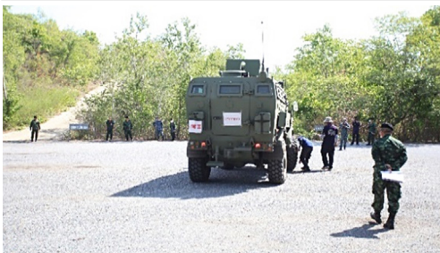
รูปที่ 9 การทดสอบบรัคมีวงเลี้ยวด้วยการโรยผงแป้งไว้ด้านข้างล้อตลอด จนทำการเลี้ยวสำเร็จ
