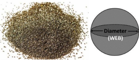
รูปที่ 4 ดินปืนแบบทรงกลม (Ball powder propellant)
