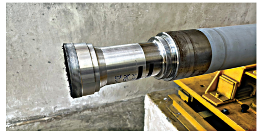
รูปที่ 8 ท่อท้ายจรวดหลังการทดสอบภาคสถิติ
