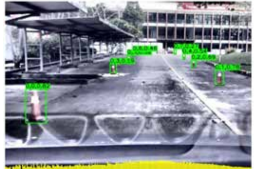
รูปที่ 8 ตัวอย่างผลการตรวจจับกรวยจราจร จากภาพแบบ CLAHE
