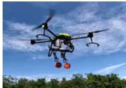
รูปที่ 13 มือจับชิ้นงาน ขณะจับลูกบอลดับเพลิง
