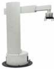
รูปที่ 4 ลักษณะแขนกลแบบ Cylindrical Robot [9]
