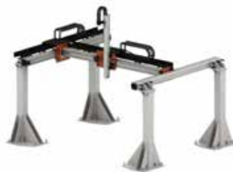
รูปที่ 3 ลักษณะแขนกลแบบ Cartesian Robot [9]
