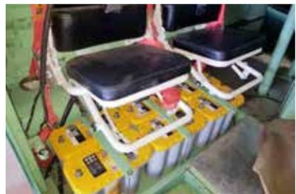
รูปที่ 4 ชุดแบตเตอรี่ที่เพิ่มเข้ามาสำหรับภารกิจยิงโดยไม่สตาร์ทเครื่องยนต์ของระบบแท่นยิงจรวดอัตโนมัติติดตั้งอยู่ 6 ลูก ได้ฝั่งพลโดยสารฝั่งซ้ายของรถฐานยิงจรวด
