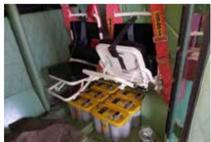
รูปที่ 5 ชุดแบตเตอรี่ที่เพิ่มเข้ามาสำหรับภารกิจยิงโดยไม่สตาร์ทเครื่องยนต์ของระบบแท่นยิงจรวดอัตโนมัติติดตั้งอีก 6 ลูก ได้ฝั่งพลโดยสารฝั่งขวาของรถฐานยิงจรวด
