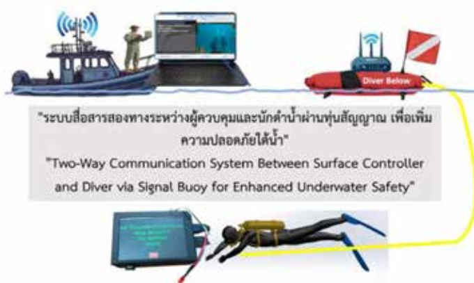
รูปที่ 1 แนวความคิดในการออกแบบระบบสื่อสารสองทางระหว่างผู้ควบคุมและนักดำน้ำผ่านทุ่นสัญญาณ เพื่อเพิ่มความปลอดภัยใต้น้ำ โดยผู้ควบคุมสามารถส่งข้อความไปแสดงบนจอที่ติดอยู่ที่ข้อมือนักดำน้ำ และที่นักดำน้ำจะส่งภาพแบบ Real Time กลับมายังผู้ควบคุมที่อยู่บนผิวน้ำ
