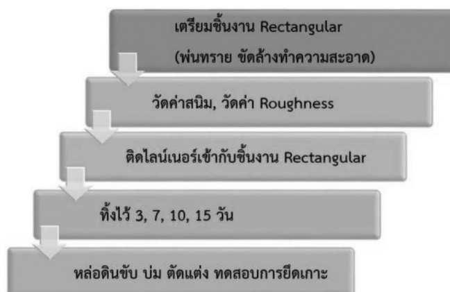
รูปที่ 2 ขั้นตอนในการเตรียมจนถึงการทดสอบการยึดเกาะไลน์เนอร์และดินขับ
