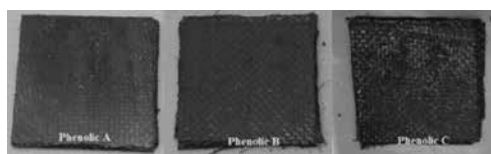
รูปที่ 6 แสดงชิ้นงานทดสอบคอมโพสิต ฟีนอลิก A, ฟีนอลิก B และ ฟีนอลิก C หลังทำการ Post-cured
