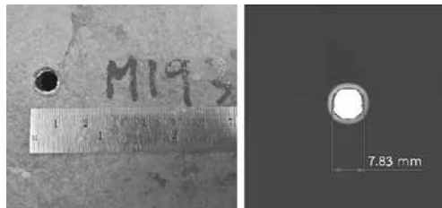
รูปที่ 9 การเปรียบเทียบรูทะลุด้านหน้าของแผ่นกันกระแทกชนิด A ที่เกิดจากการทดสอบจริงกับการจำลองด้วยโปรแกรม
