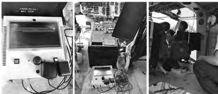
รูปที่ 9 แสดงการติดตั้งต้นแบบเครื่องบินที่ตำแหน่งและทำทางการบินบนเฮลิคอปเตอร์แบบ UH-1H
