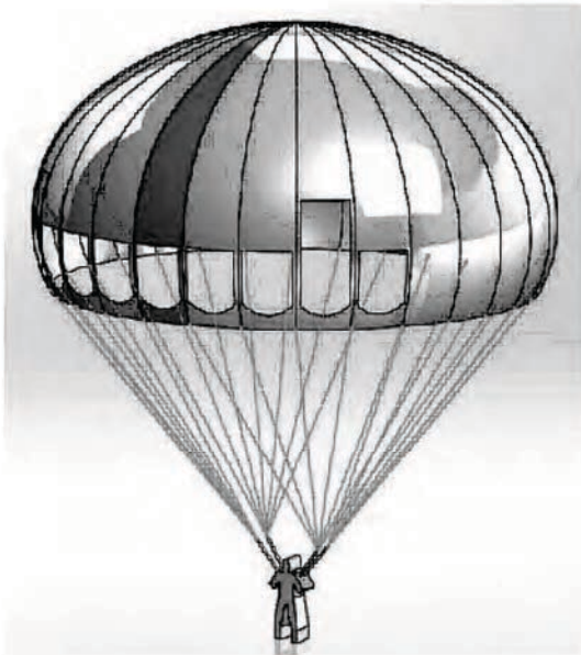
รูปที่ 2 แสดงภาพเครื่องช่วยฝึกบินบังคับร่มจากไฟล์ CAD
