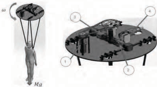
รูปที่ 6 มอเตอร์ 4 ตัว ของเครื่องช่วยฝึกบังคับร้อม
