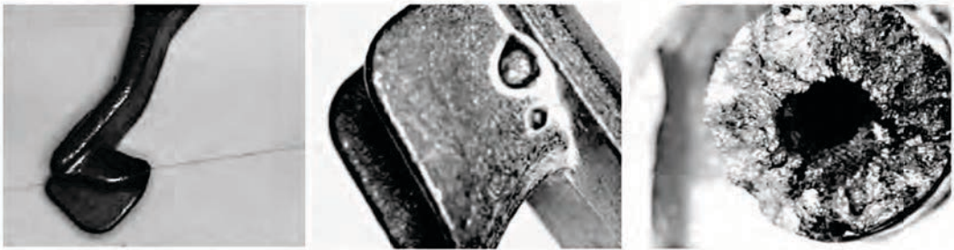
รูปที่ 5 ความเสียหายที่ได้รับผลกระทบต่อการหล่ออินเวสต์เมนต์
