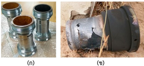
รูปที่ 1 ปลายท่อจรวดขนาด 122 มม. (ก) ก่อนใช้งาน และ (ข) หลังการใช้งาน
