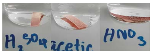
รูปที่ ๗ ฟองก๊าซที่เกิดขึ้นบนแผ่นโลหะทองแดงที่แช่ในสารละลายกรดซัลฟิวริก กรดแอซติก และกรดไนตริก ขณะเริ่มต้นการทดลอง
