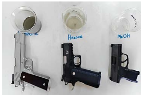
รูปที่ ๔ หลังจากนำปืนยิงทดสอบมาล้างคราบเขม่าด้วยน้ำยาสารอินทรีย์
