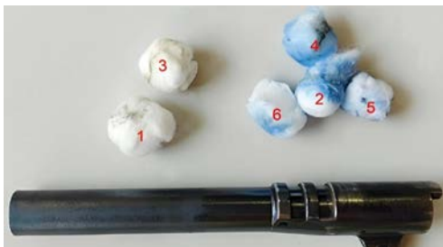
รูปที่ ๑๔ ผลการล้างคราบทองแดงด้วยน้ำกลั่นและน้ำยาล้างคราบทองแดง
