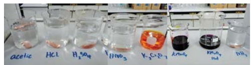
รูปที่ ๖ การแช่แผ่นโลหะทองแดงลงในสารละลายชนิดต่าง ๆ ได้แก่ กรดแอซติก กรดไฮโดรคลอริก กรดซัลฟิวริก กรดไนตริก โพแทสเซียมไดโครเมต โพแทสเซียมเปอร์แมงกาเนต และแอมโมเนีย
