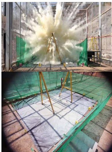
รูปที่ 20 การกระจายสารดับเพลิงในพื้นที่เปิดโล่ง
