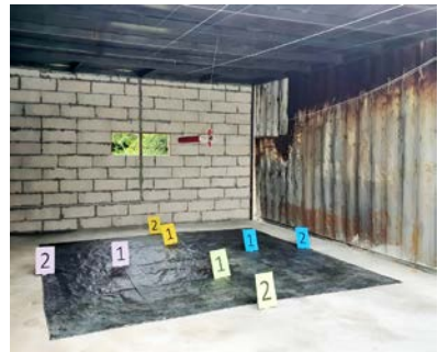
รูปที่ ๑๓ การทดสอบระยะการกระจายตัวของสารดับเพลิง
