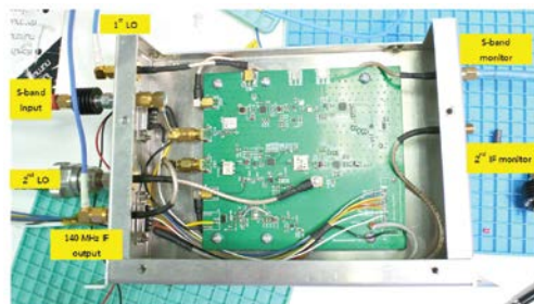
รูปที่ ๗ วงจรแปลงความถี่ลงย่านเอสแบนด์เป็นวีเอชเอฟต้นแบบ
