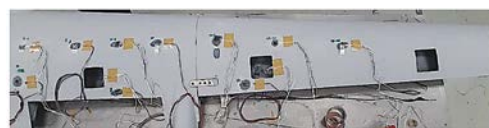
รูปที่ 20 การติดตั้ง Strain Gauges กับผิวปีก
