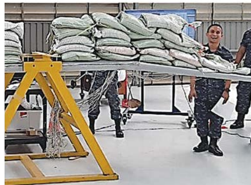
รูปที่ 29 การทดสอบปีก (แผนแบบใหม่) ด้วยถุงทราย
