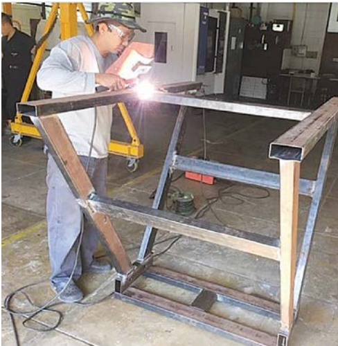
รูปที่ 15 การดำเนินการสร้างแท่นทดสอบ
