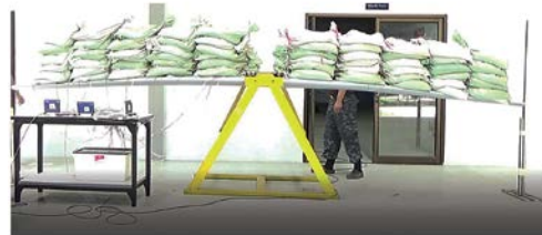
รูปที่ 19 การทดสอบความแข็งแรงโครงสร้างปีกด้วยถุงทราย ที่ภาระกรรมขนาด 900 กิโลกรัม
