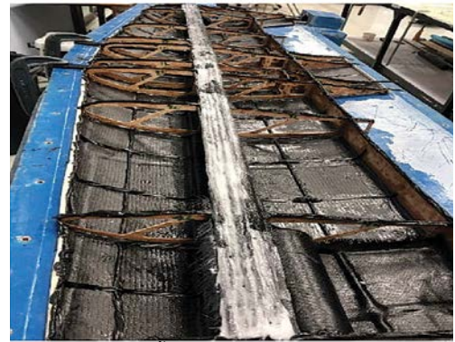
รูปที่ 26 การขึ้นรูปโครงสร้างปีก (แผนแบบใหม่)
