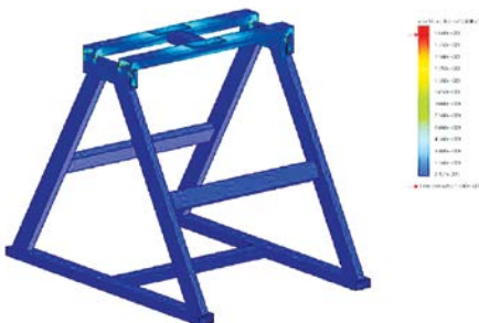
รูปที่ 13 แบบสามมิติของแท่นทดสอบและการวิเคราะห์เชิงกล
