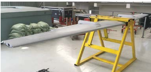
รูปที่ 16 โครงสร้างปีกไทเกอร์ซาร์ก 2 (แผนแบบเดิม) ติดตั้งประจำแท่นทดสอบ
