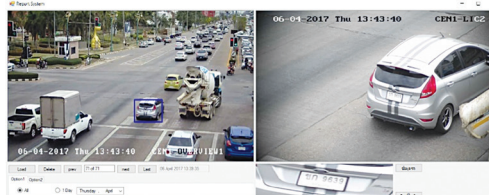
รูปที่ 14 ตัวอย่างการทำงานตรวจจับยานพาหนะและป้ายทะเบียน
