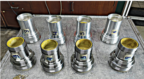
รูปที่ 5 ชิ้นงานฉนวนส่วนต่อท้ายจรวดส่วนหน้าและส่วนหลัง
