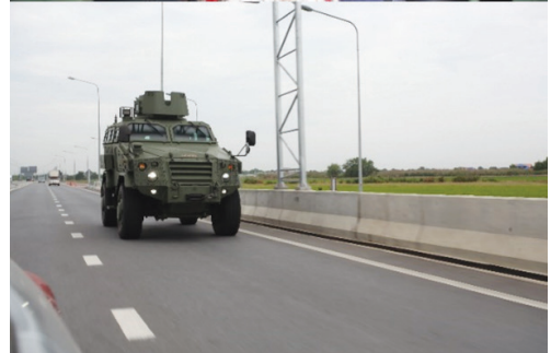
รูปที่ 13 การทดสอบวัดความดังเสียงภายในห้องโดยสารโดยการติดอุปกรณ์วัดความดังและทำการวิ่งทดสอบทั้งขณะรถเคลื่อนที่และไม่เคลื่อนที่
