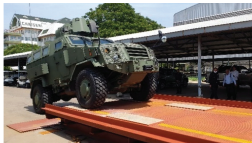
รูปที่ 11 การทดสอบข้ามเครื่องกีดขวางสูงที่ความสูง 50 cm โดยรถมีกำลังเพียงพอสามารถผ่านไปได้
