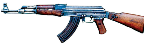
รูปที่ 2 แสดงปืนแบบ AK-47 ที่ใช้ระบบปฏิบัติการด้วยแก๊สแบบก้านกระทุ้งระยะชักยาว
